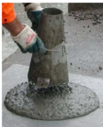
شکل ۳-۲ انجام آزمایش جریان اسلامپ
