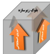
اندرکنش فاک-سازه در سافت بالا به پایین نیروی عظیم اصطکاکی رو به بالا بر روی زیرسازه
