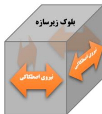
اندرکنش فاک-سازه در سافت بالا به پایین نیروی عظیم اصطکاکی افقی بر روی زیرسازه
