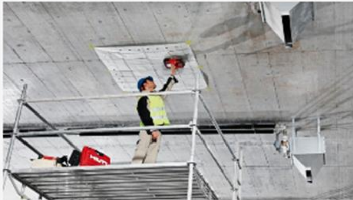
اسکن میلگرد (آرماتور) در بتن
