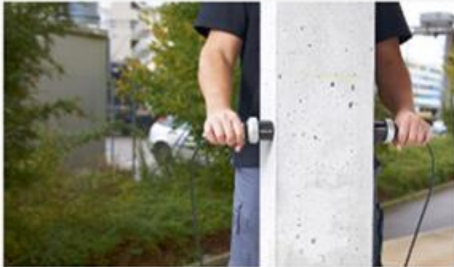
تست التراسونیک بتن (UPV)
