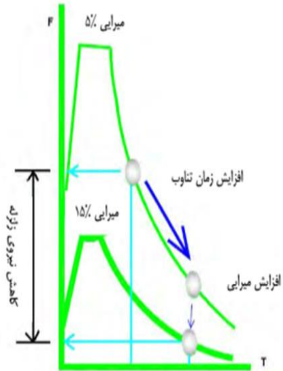
شکل ۶-۱ - تأثیرات استفاده از جداسازهای لرزه ای بر طیف پاسخ سازه‌ها
