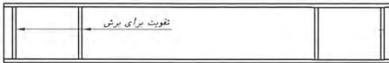
شکل ۲-۴-۲۳- اضافه نمودن ورق های سخت کننده عرضی
